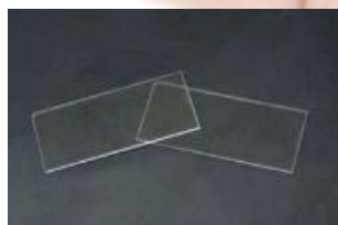
<合成石英スライドガラス Labo-Slide> 紫外～近赤外域まで高い透過率を誇る 高純度合成石英製のスライドガラスです
