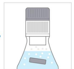
キャップをひねると内ぶたが落ち、水素吸蔵パウダーが水に溶け込みます
