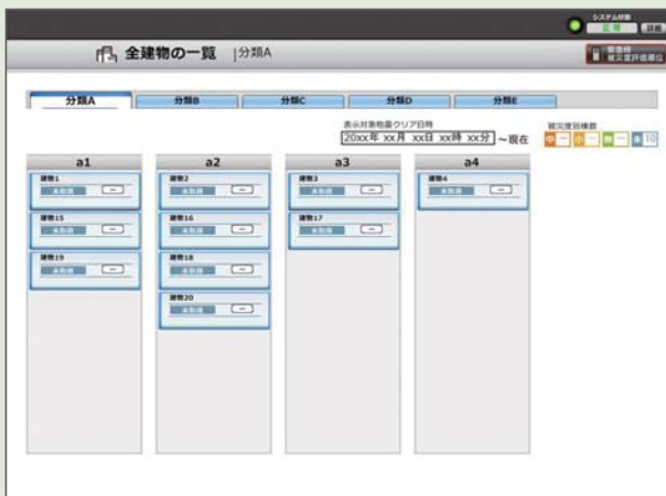
◆各施設の被災度、震度、加速度、システム動作状況を一覧で確認できます。
