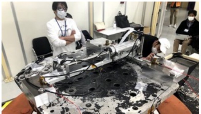
放出機構 振動試験の様子
