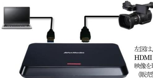
左図は、DarkCrystal 750 とカメラを HDMI で接続し、ラップトップ PC で 映像を取り込む時の接続図です。
