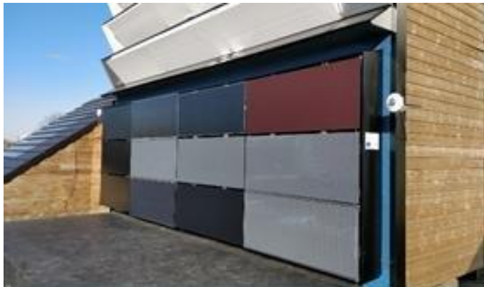
画像出典：Chris Tzikas (SAEC) "Outdoor Characterization of Colored and Textured Prototype PV Facade Elements" (2018年11月)
