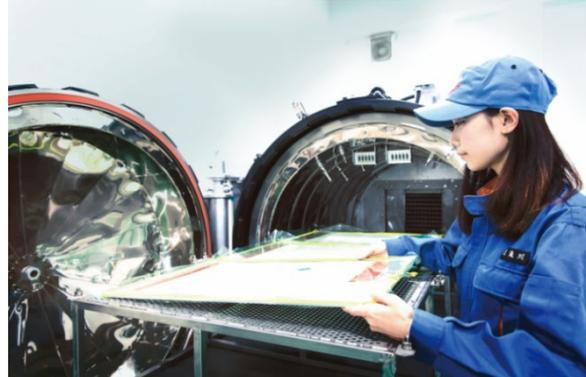
炭素繊維系複合材(CFRP)部品成型実習
