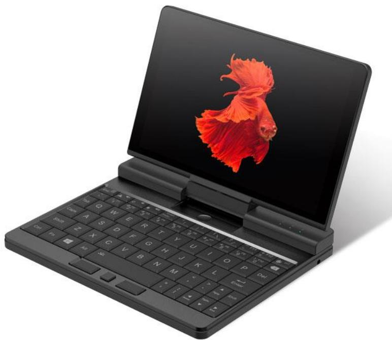
One-Netbook A1 は、画面サイズ7インチ以下のUMPCにおいて、約10年ぶりに日本語キーボードを搭載した Windows 搭載 UMPC となります。One-Netbook 社が新たに独自開発した3軸ヒンジにより、軽量小型ながらなめらかな回転と高い耐久性を実現し、タブレットやノートパッドとしても利用できます。さらに、性を実現し、タブレットやノートパッドとしても利用できます。さらに、文庫本サイズの7インチ約550gのコンパクトながら USB Type-C ポート、2つの USB Type-A ポート(USB 3.0)、microHDMI ポートや RS-232C シリアルポートなどを搭載することで高い拡張性も実現しています。そのため、IT エンジニアや出張の多いビジネスパーソン、ご自宅でのテレワークなど幅広く活用いただけます。
