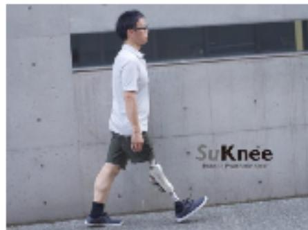
**概要:**既存の義足は動力を持たないのが主流で、膝関節の自律的屈伸ができない為、つまずいた場合、力を出して反発することができず転んでしまう。これに対し、生体メカニズムに基づき、ロボット技術と人間の筋肉を模倣する独自のアクチュエータを開発・融合することにより、軽量、コンパクトかつ電動アシスト機能を備えた義足をデザインした。膝の伸展・屈曲・振出、椅子からの起立、階段の昇降をアシストすることで、転倒の防止、疲れにくく、自然で安全な歩行が可能になる。
