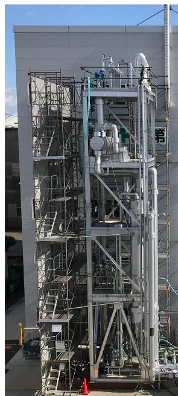
汎用ヒートポンプ式蒸留装置
