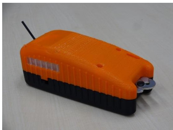
ドローンに取り付ける本体装置 金属製のフックでリードロープを引っ張る
