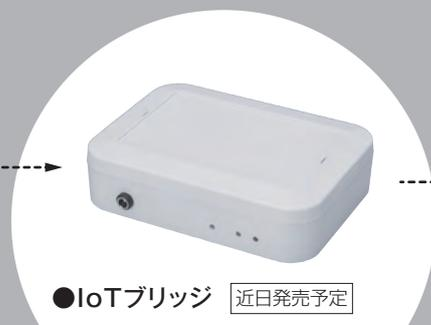
BLEレシーバー機能を持つ「IoTブリッジ」は「スマートキャスター」から送信されるBLEの電波を受信することで運搬機器の測位を行えます。
