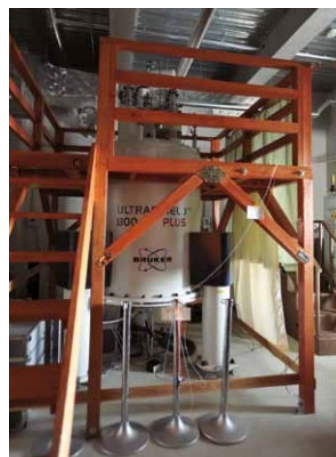
図3. 800MHzのNMRの写真
